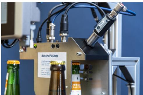
Dichtigkeitsprüfung mit Anregereinheit und Luftschallsensor
